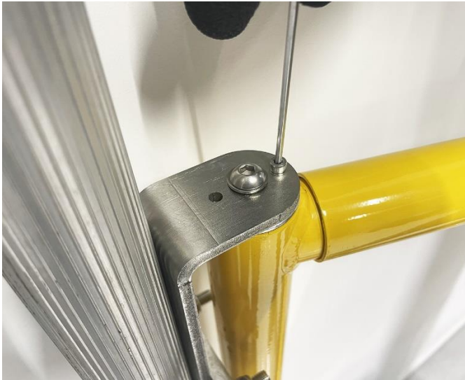
Odkręć blokadę imbusem 3mm
