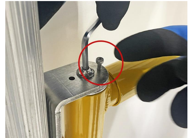
Przykręć śrubkę blokującą
