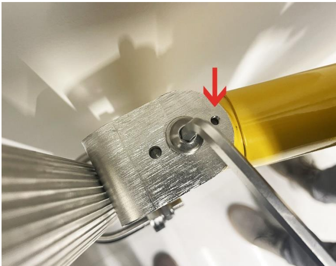
Obracając śrubą zwróć uwagę aby zatrzymać obrót aby móc z powrotem przykręcić śrubkę blokującą
