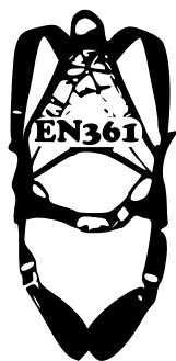
Rys. 7 – Szelki bezpieczeństwa zgodne z normą EN361
